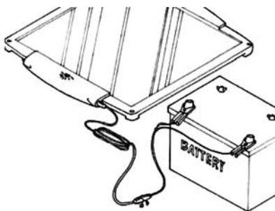
**Pozor:** Odstranite zaščitne kapice na priključkih preden na njih priključite kable. Najprej priključite vtič (kabel sive barve) na priključek na solarnem panelu. S kablom po vaši izbiri, priključite solarni polnilec na akumulator. Nazadnje povežite konec akumulatorskega kabla z vtičem podaljšane kabla (vtič je črne barve).
