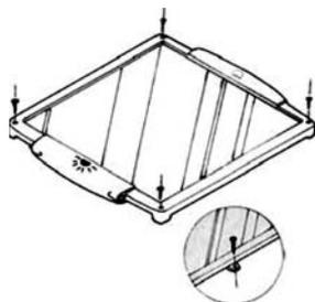
Solarni panel postavite na izbrano mesto inštalacije. Usmerite panel pravokotno proti najmočnejšemu opoldanskemu soncu. Vstavite vijake in previdno pritrnite panel.
